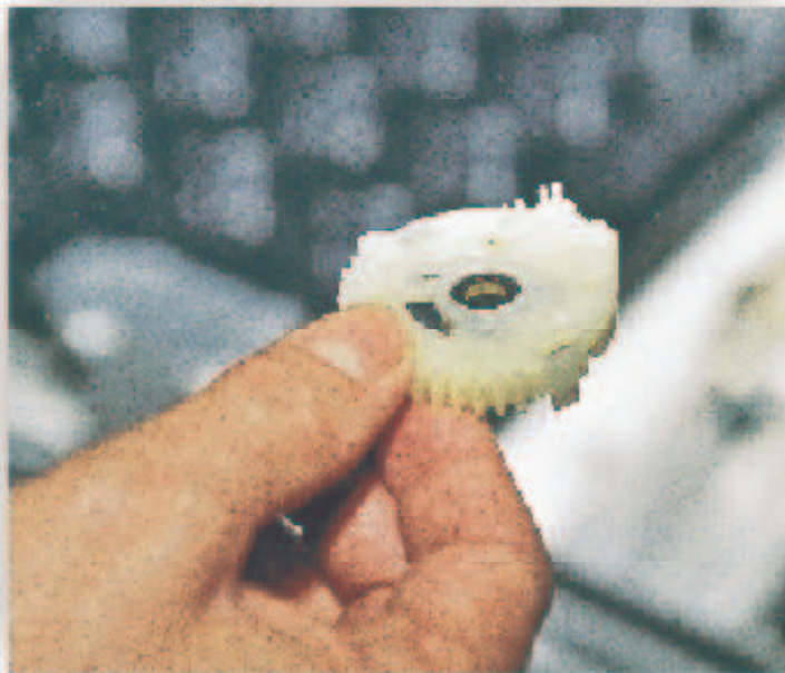
Das Antriebsritzel besteht aus PA 6.6 mit einem Glasfaseranteil von 30 %, das Teilgewicht inklusive Einlege-teil beträgt etwa 11 g (Bilder: Plastverarbeiter, Fischerwerke)
